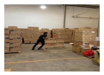
Gambar 3.1 Operator tidak menggunakan APD
