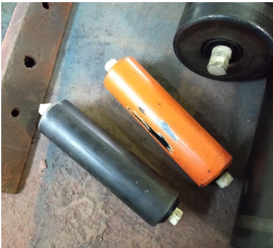
Lampiran 13 : Produk roller conveyor yang cacat
