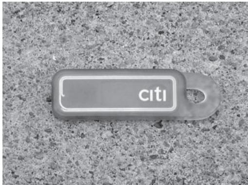
**FIGURE 2.2** Common RFID tag.
